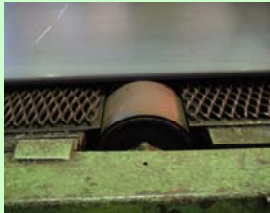
1,000トンプレス騒音防止ゴム
